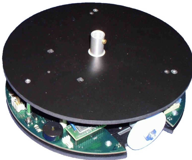
Obrázok 1. Robotnačka – kresliaci robot.
