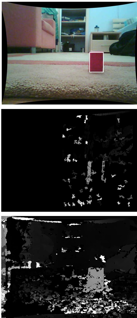
Obr. č. 23: Zhora nadol: ľavý záber, výstup StereoBM, výstup StereoSGBM
