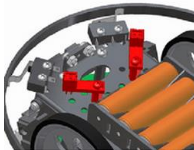
Obr. 2.3: Umiestnenie line senzorov[16]
