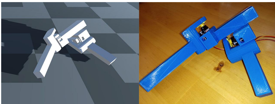
Obr. 24 – Testovaný jedinec vytvorený na 3D tlačiarňi vedľa pôvodného jedinca vyvinutého v simulácii
