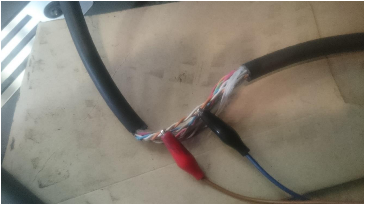
Obr. 27 Záznam komunikácie medzi OBD a VOCOM
