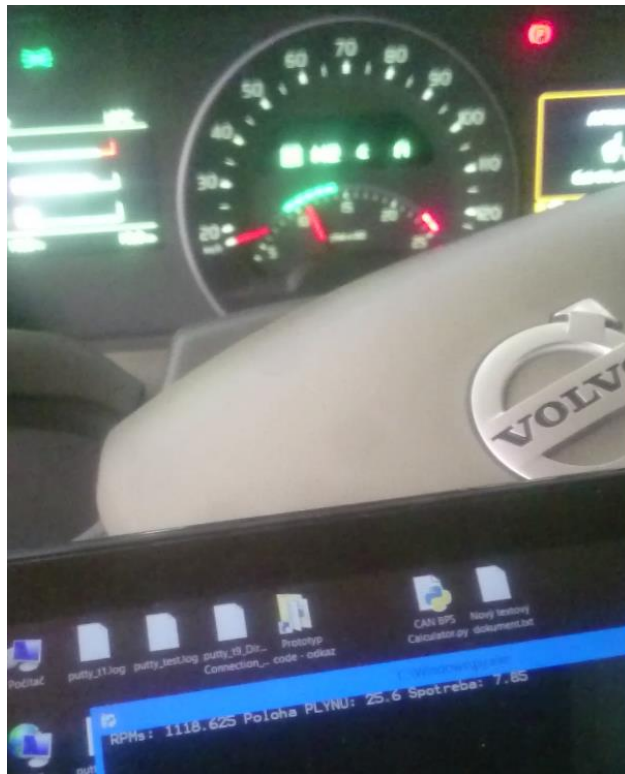
Obr. 25 Test načítania otáčok motora
