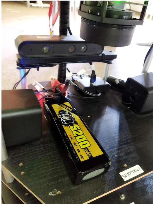
Obrázok 20 Batéria, ktorá napája Raspberry Pi 4 a ethernetový switch
