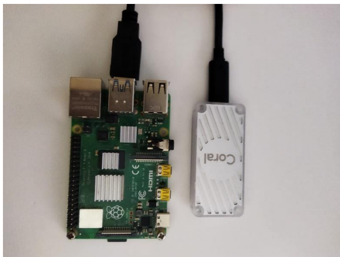
Obrázok 16 Raspberry Pi 4 so zapojeným Google Coral USB akcelerátorom cez USB3.0
