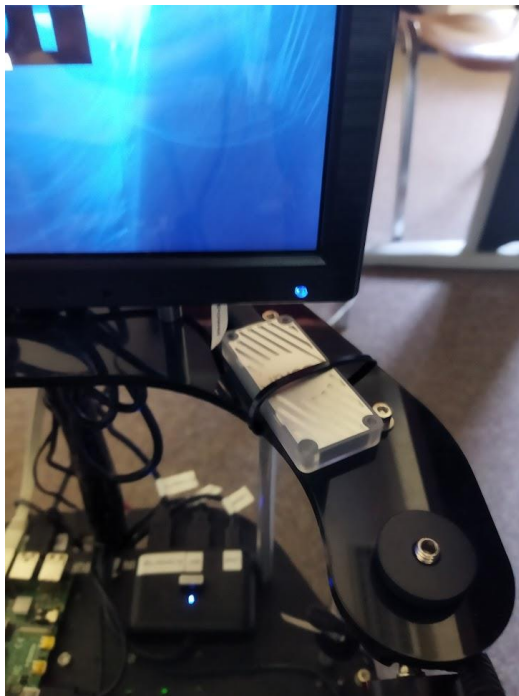
Obrázok 21 Google Coral USB akcelerátor pripevnený na robotovi Jupiter
